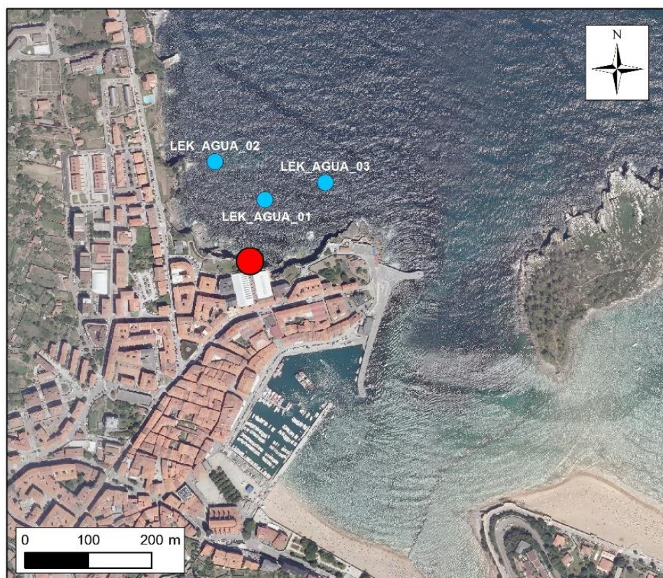
Figura 4.1. Estaciones de muestreo de aguas en el entorno de los vertidos de la EDAR de Lekeitio. El punto de vertido se señala con círculo rojo.
